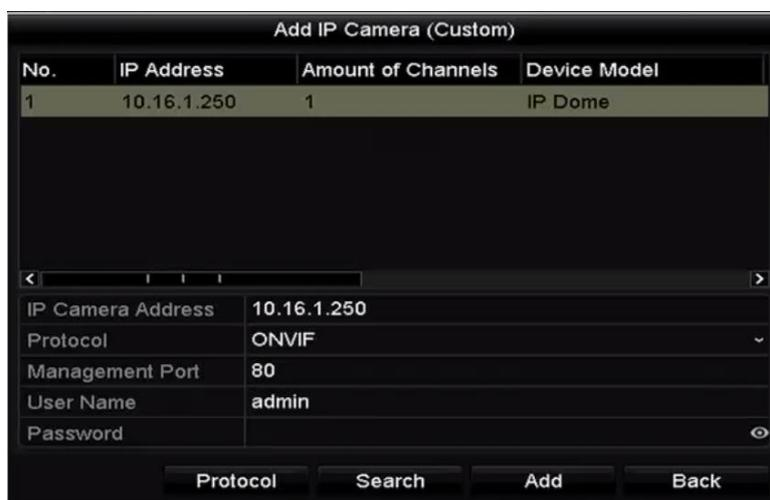
Рисунок 4.12 Добавление IP-камеры
