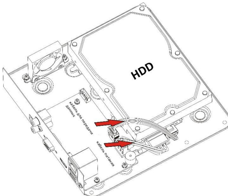
Рисунок 2.3 Подключение кабелей
