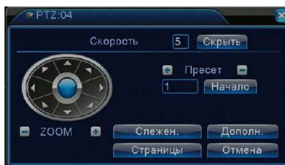
Рисунок 3.10 Настройка движений(PTZ) камеры
