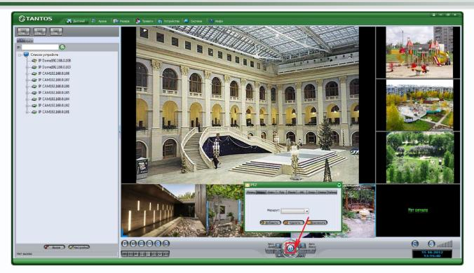
Есть два пути создания маршрута – задать предварительно заданные позиции (пресеты) и переходы между ними или провести камеру по маршруту, запомнить его и потом камера будет автоматически двигаться по запомненному маршруту.
