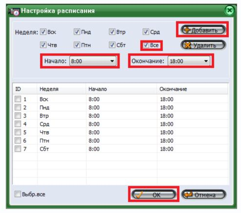
В соответствии с техническим заданием камеры должны обеспечивать непрерывную запись в дневное время (с 8.00 до 18.00).
