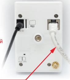
Для начала работы камеру необходимо подключить к сети Интернет при помощи проводного соединения или беспроводного соединения Wi-Fi (для камер CD320, CD330). В большинстве случаев, для подключения к интернет-соединению необходимо наличие роутера (маршрутизатора) или точки доступа (с функцией роутера).
