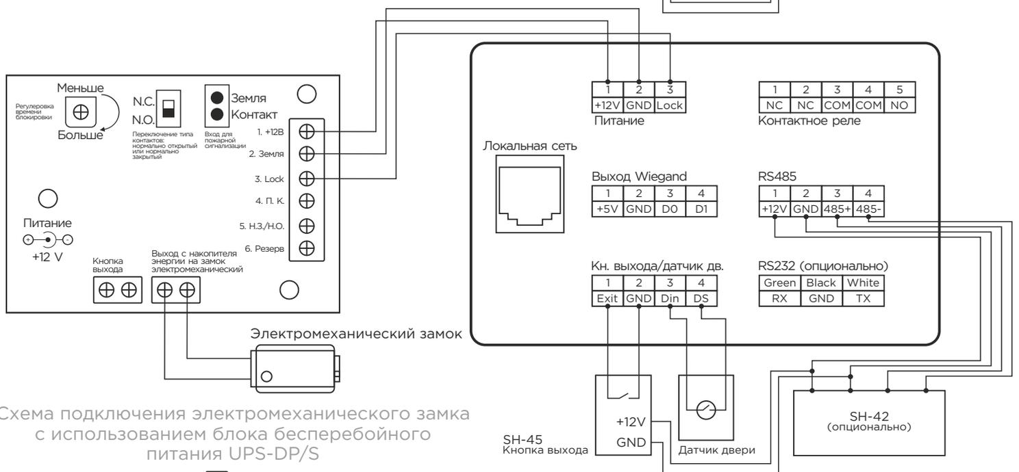
Схема подключения электромеханического замка с использованием блока бесперебойного питания UPS-DP/S
