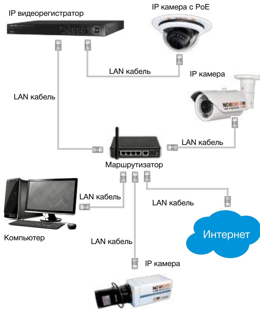
Рисунок 3.19 Подключение IP видеорегистратора с PoE.
