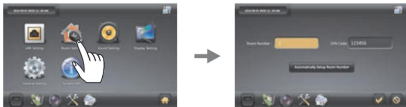
**Предупреждение!** Убедитесь что SYN код на всех мониторах один и тот же. В этом случае они будут связаны с основным монитором в одну сеть. После включения питания подождите несколько секунд для загрузки устройств системы домофона и они отобразятся в меню основного монитора.
