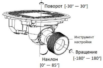
Рисунок 1-23 Настройка угла наблюдения камеры
