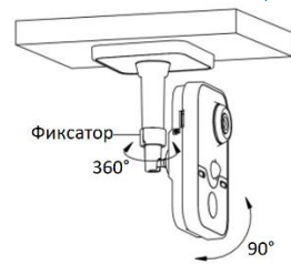
Рисунок 1-25 Настройка угла наблюдения камеры
