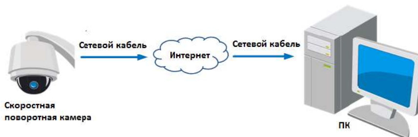
Рисунок 2-11 Доступ напрямую к камере со статическим IP-адресом
