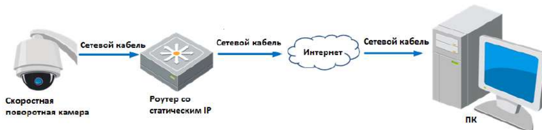
Рисунок 2-10 Доступ к камере через роутер со статическим IP-адресом
