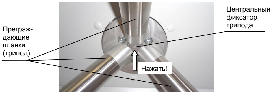
Рис.4 Место расположения центрального фиксатора трипода
