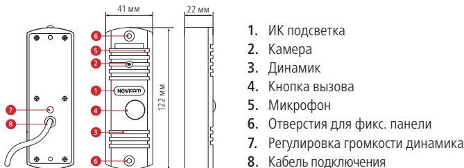
Рис. 7 Вызывная панель, входящая в комплект SMILE 4/7 KIT
