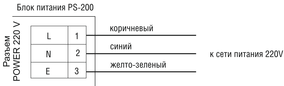
Рисунок 7.6.1 Схема подключения блока питания
