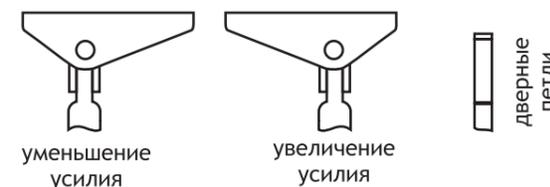
Дополнительно можно настроить усилие закрытия ( $\pm 5\%$ ), переворачивая кронштейн регулируемого рычага. Для уменьшения усилия необходимо расположить ось рычага дальше от петель. Для увеличения усилия - ближе. (Пример для двери правого исполнения).
