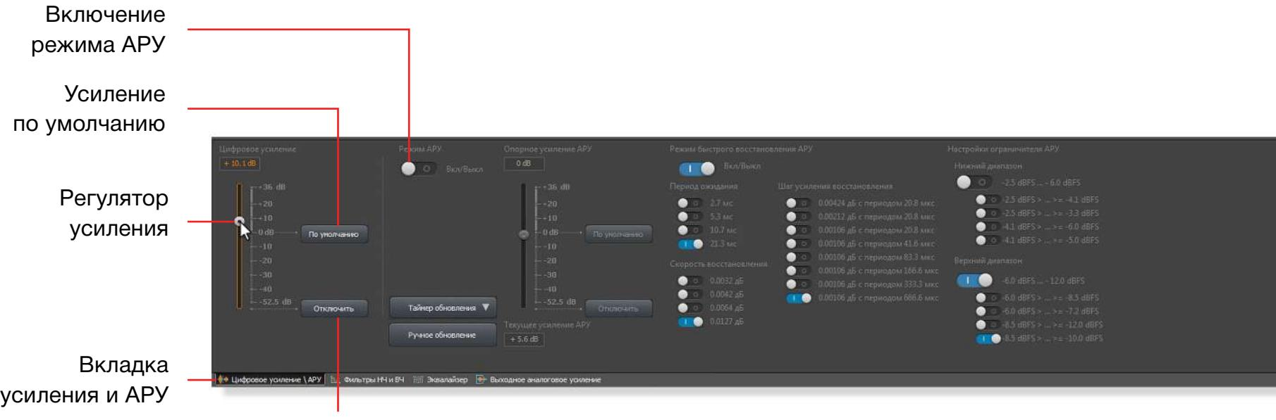
Ручная регулировка усиления позволяет быстро отрегулировать уровень усиления устройства. Обычно ручная регулировка применяется к устройствам, которые расположены в помещениях, где уровень сигнала не сильно меняется.
