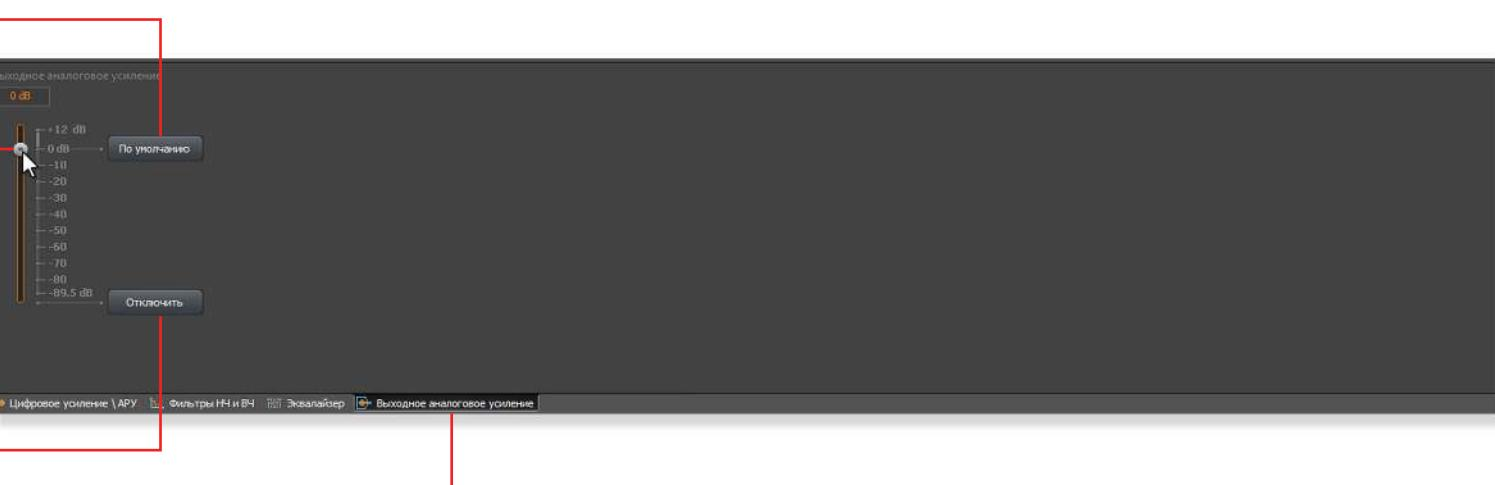
При помощи этого регулятора можно усилить или ослабить сигнал, который поступает на линейный аудиовыход.
