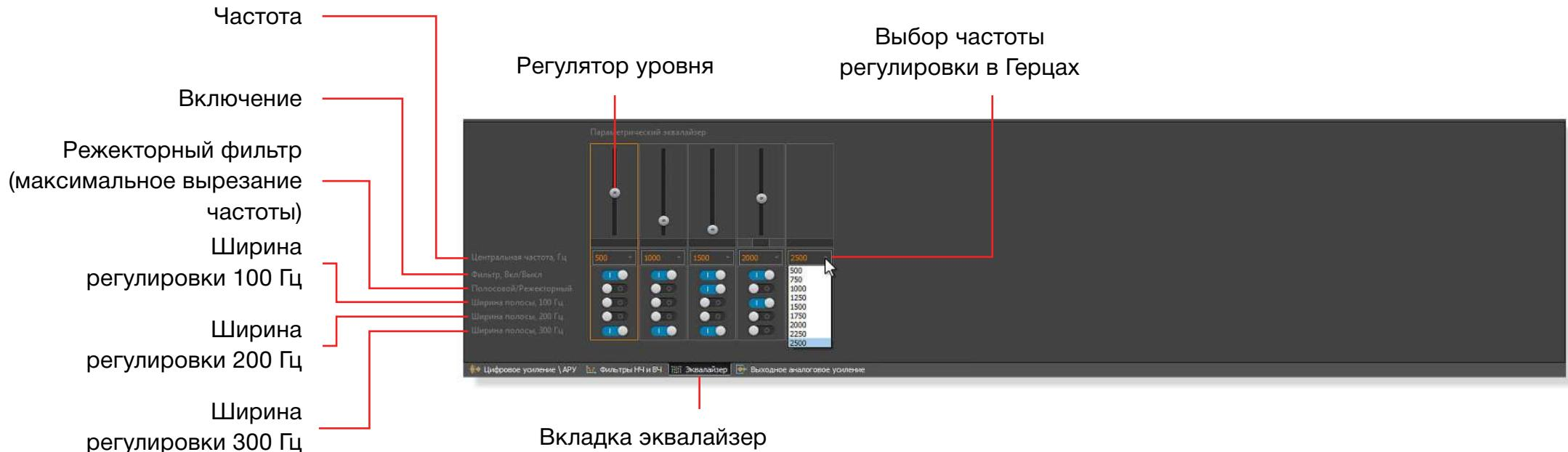
Параметрический эквалайзер позволяет ослабить или усилить выбранную частоту, с заданной шириной регулировки. Это очень полезная функция, позволяющая убрать те или иные звуки, например звук считывателя карт доступа или звук сканера этикеток на кассе. Для того чтобы включить любой из блоков управления, необходимо кликнуть на переключатель **Фильтр Вкл/Выкл**.
