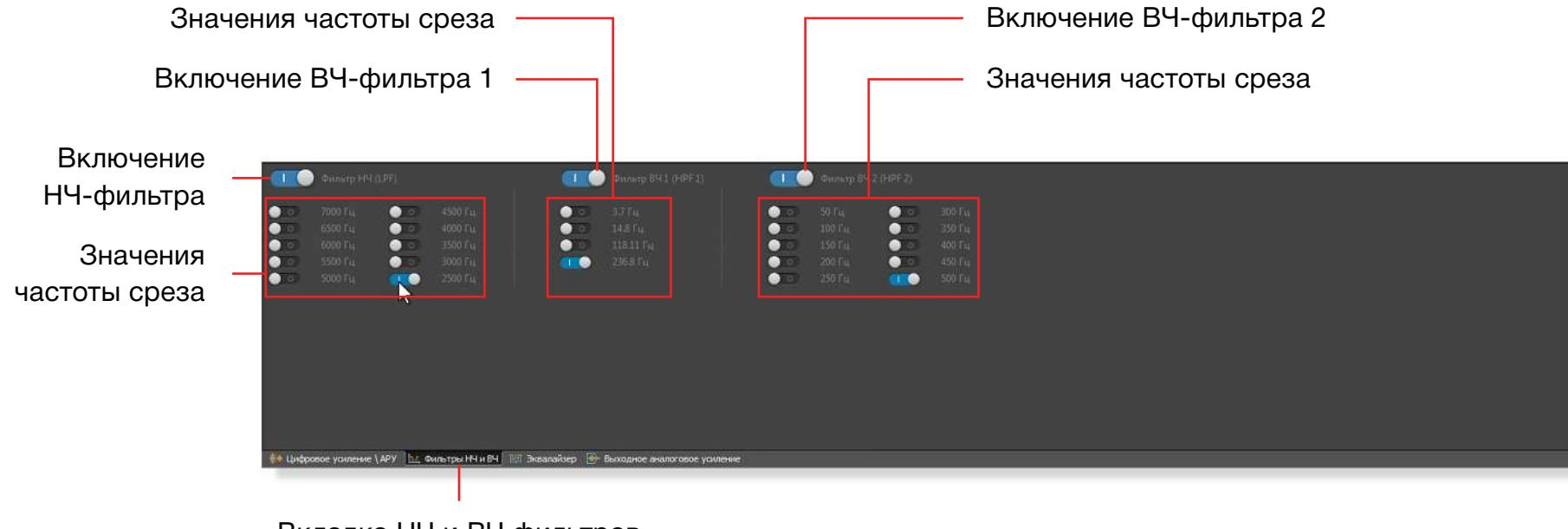
Вкладка НЧ и ВЧ фильтров содержит 1 фильтр низких частот и 2 фильтра высоких частот.
