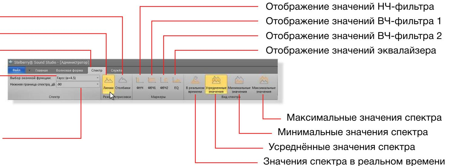
Во вкладке **Спектр** можно задать параметры, по которым будет отображаться спектр сигнала.
