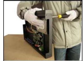
3. закрутите винты HDD
