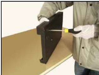
4. закрутите винты HDD
