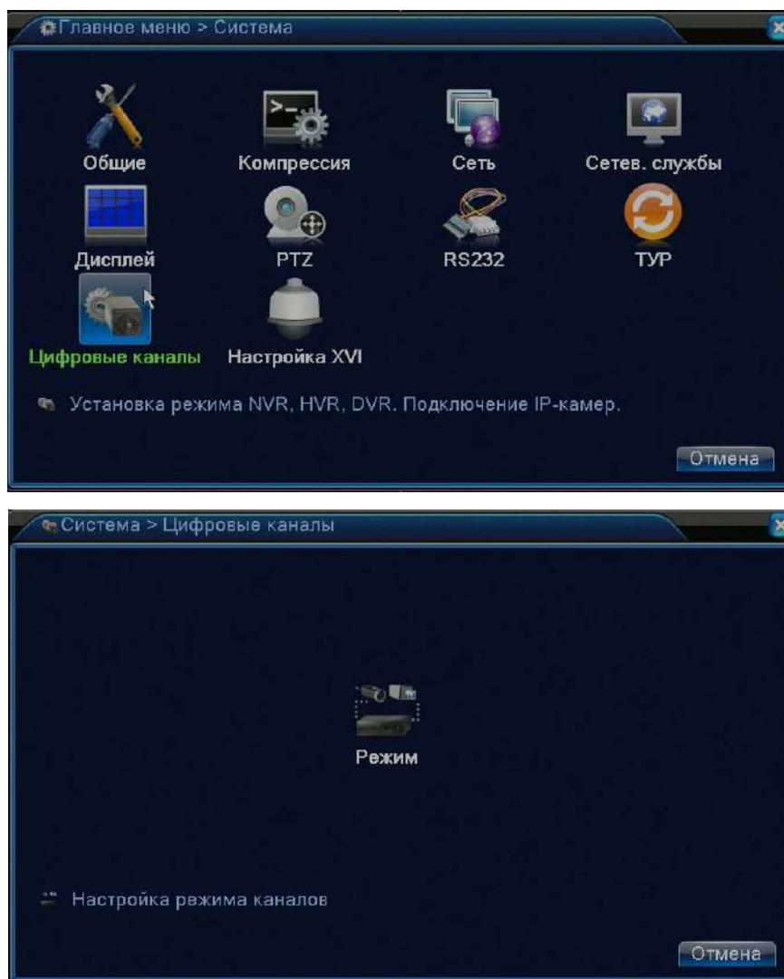
Рисунок 4.34 Управление каналами в полностью аналоговом режиме (DVR)
