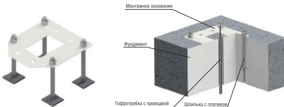
Рисунок 7.1.1 Устройство фундамента с монтажной пластиной
