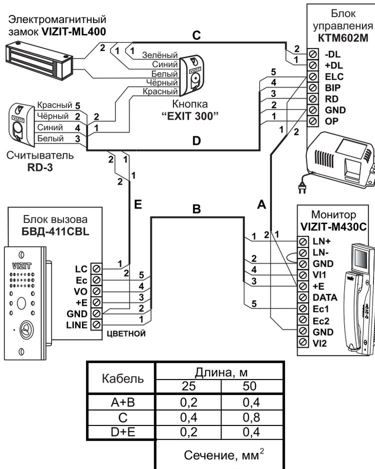
Рисунок 11 - Схема соединений **БВД-411СВЛ** с блоком управления **КТМ602М**, считывателем **RD-3**, монитором **VIZIT-M430C**, электромагнитным замком **VIZIT-ML400** и кнопкой **"EXIT 300"**
