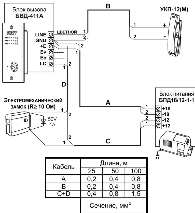
Рисунок 6 - Схема соединений БВД-411А с УКП-12(М)
