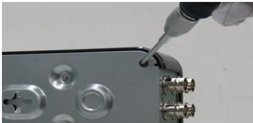
Снимите верхнюю крышку регистратора на нижней части корпуса.
