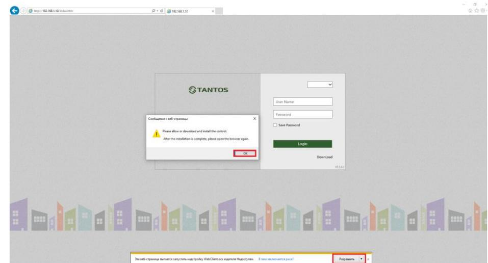
Для получения доступа к устройству укажите в адресной строке браузера IP-адрес, присвоенный камере. После откроется окно приглашения и ввода пароля, как показано на
