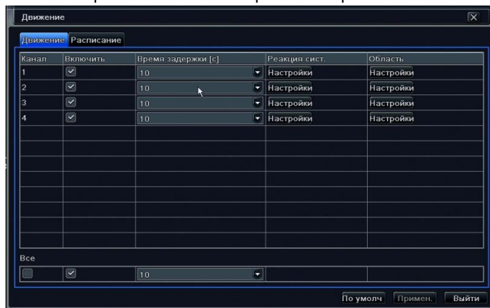
Рис. 4.20. Настройка детектора движения.
