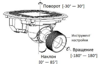
Рисунок 1-25 Настройка угла наблюдения камеры
