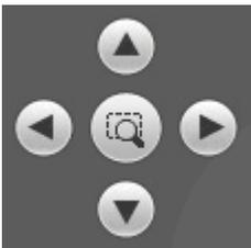
**[Джойстик вверх], [Джойстик вниз]:** с помощью данных кнопок осуществляется переход между пунктами меню, а также, при настройке конкретного параметра, выбор его значения.
