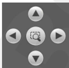
**[Джойстик вверх], [Джойстик вниз]:** с помощью данных кнопок осуществляется: при просмотре изображения – поворот камеры вверх/вниз; при нахождении в экранном меню настроек – переход между пунктами меню, а также, при настройке конкретного параметра, выбор его значения.
