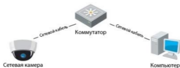
Рисунок 3-2 Соединение через коммутатор или роутер
