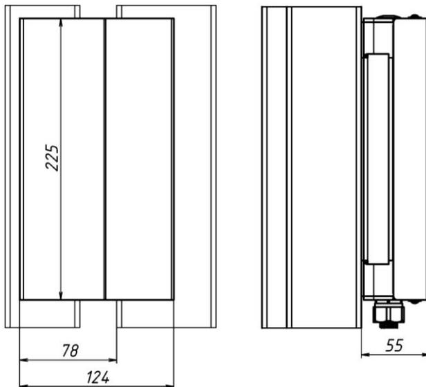
Рисунок 5 – Габариты комплекта в проеме двери
