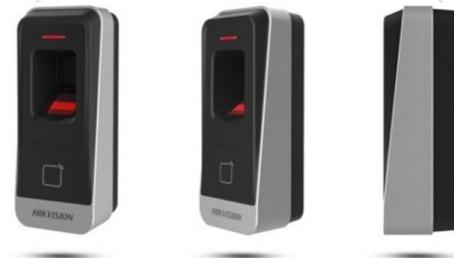
Считыватель серии DS-K1201 является считывателем отпечатков пальцев и карт; оснащен 32-битным высокоскоростным процессором и модулем оптического распознавания отпечатков пальцев. Связь с контроллером доступа выполняется по протоколу RS-485. Встроенный датчик контроля вскрытия помогает защитить считыватель карт от злонамеренного повреждения.
