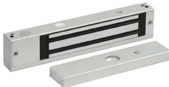
Электромагнитный замок ST-EL140L предназначен для запираения дверей, контролируемых СКУД, а также дверей эвакуационных выходов. Одноцветная световая индикация обеспечивает визуализацию различных состояний замка: СИД не горит – нет питания, красный сигнал – на замок подано питание. Для преодоления остаточной намагниченности в устройстве используется специальное цинковое покрытие якоря замка совместно с пружинным механизмом.
