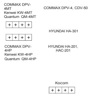
**Примечание:** У мониторов, имеющих разъем для подключения видеопамяти (DPV-4HP, QM-4HP, KW-4HP, HA-200 и другие) при отсутствии видеопамяти на данном разъеме ставится перемычка. Иногда данная перемычка не ставится в разъем на предприятии-изготовителе, а поставляется в отдельном пакетике. **Без правильно установленной перемычки данные мониторы не будут показывать изображение с видеокамеры панели!**
