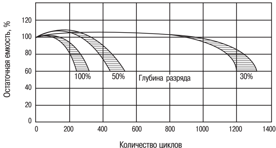
Рис. 11 Зависимость количества циклов от глубины разряда аккумуляторов Ventura.
