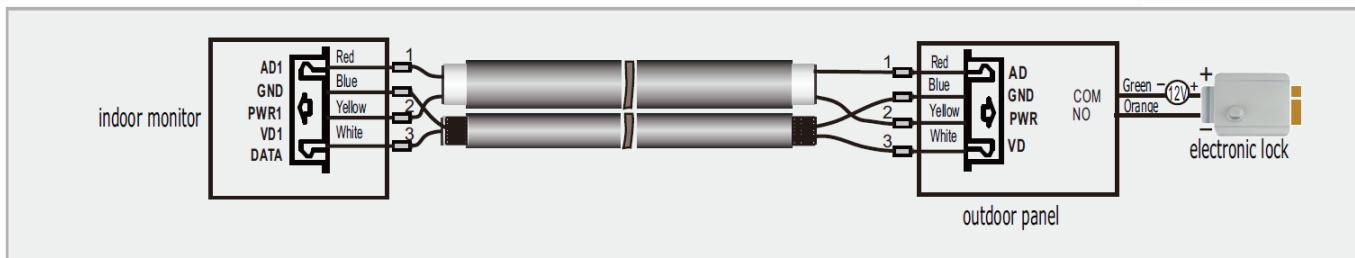
Примечание: экран экранированного кабеля настоятельно рекомендуется подключить к общему проводу (GND)
