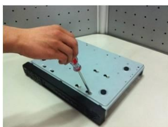
Замацуеце жорсткі дыск на ніжняй панэлі пры дапамозе шруб праз соотвѣтствующие адтуліны.
