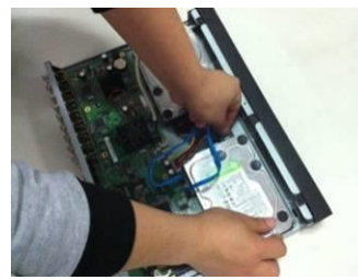
Падключыце SATA кабель і кабель харчавання на ніжняй і задняй частцы корпуса і зачыніце корпус верхняй вешкам.
