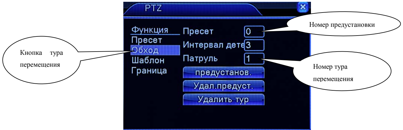
Рис. 3.13 Настройки перемещения между точками
