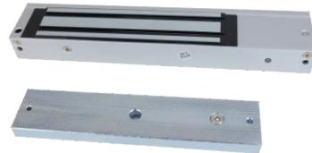
Замок DS-K4H255S является электромагнитным замком и предназначен для установки на деревянных, стеклянных и металлических дверях. Основной материал: алюминий. Максимальная сила удержания замка составляет 272 кг. Применяется для управления открытием / закрытием двери. Безопасная автоматизация контроля доступа и увеличенный срок службы электромагнитного замка благодаря конструкции с нулевым остаточным магнетизмом.
