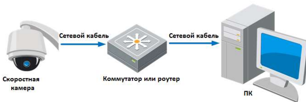
Рисунок 2-2 Подключение через коммутатор или роутер
