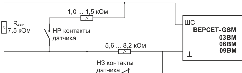
Рис.7. Схема включения технологических датчиков в ШСТ.
