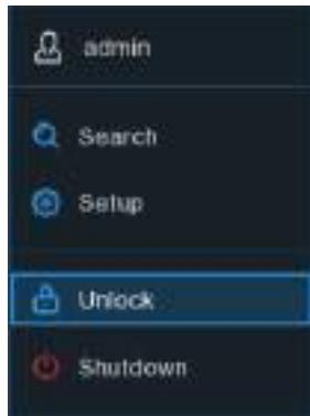
Если DVR-устройство не используется в течение 1 минуты – экран автоматически блокируется с целью защиты от несанкционированного доступа к экранному меню.
