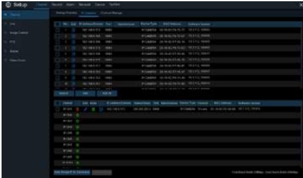
Нажмите [Поиск](#) для поиска IP камер в локальной сети, нажмите [Добавить](#) для добавления определенной IP камеры, нажмите [Добавить все](#) для добавления всех IP камер.
