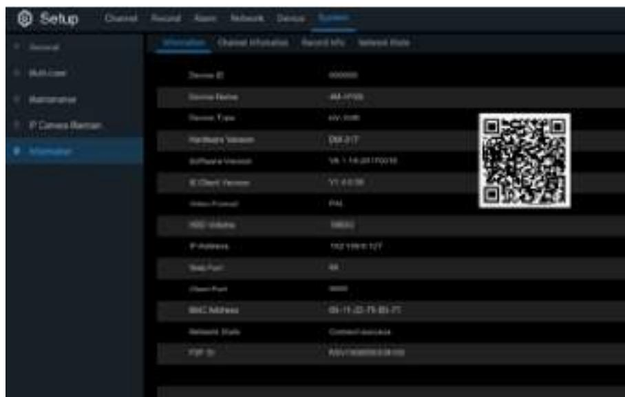
Вы найдете код P2P ID и P2P QR код на информационной странице, если DVR-устройство поддерживает функцию P2P. Вы можете отсканировать QR-код с помощью мобильного приложения для удаленного доступа к DVR-устройству.
