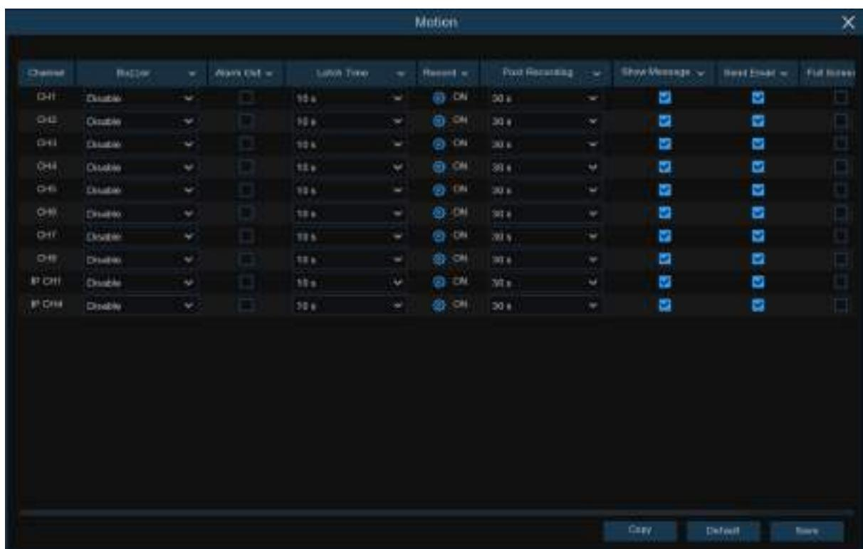
**Зуммер:** DVR-устройство может использовать внутренний зуммер в качестве сигнала тревоги. Вы можете установить продолжительность сигнала тревоги в секундах при обнаружении ИК-сенсором движения в заданной области.
