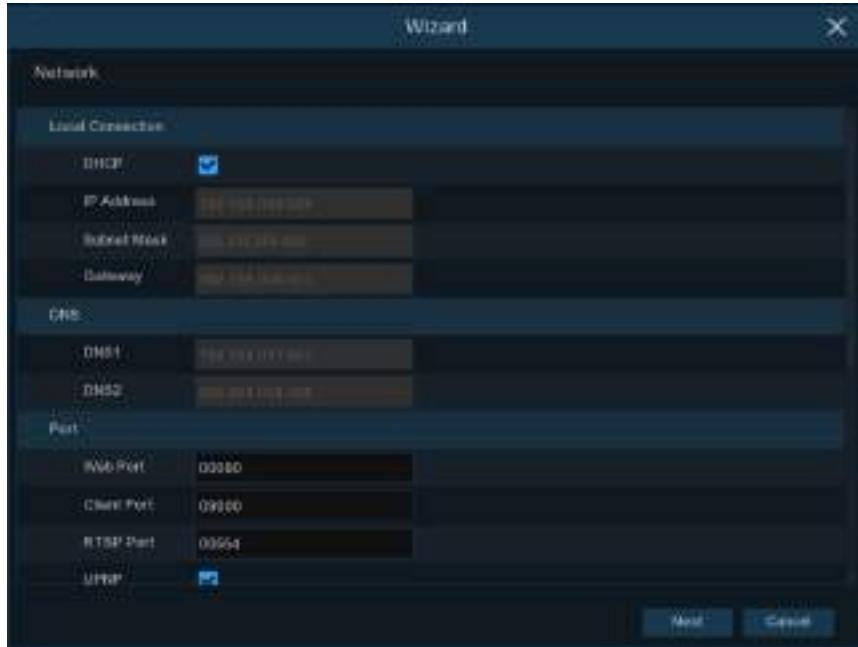
Поставьте флагок в окошке **DHCP** при подключении к маршрутизатору, который позволяет использовать DHCP-протокол. Маршрутизатор автоматически назначит параметры сети для DVR-устройства. Вы можете вручную сконфигурировать сеть по следующим параметрам:
