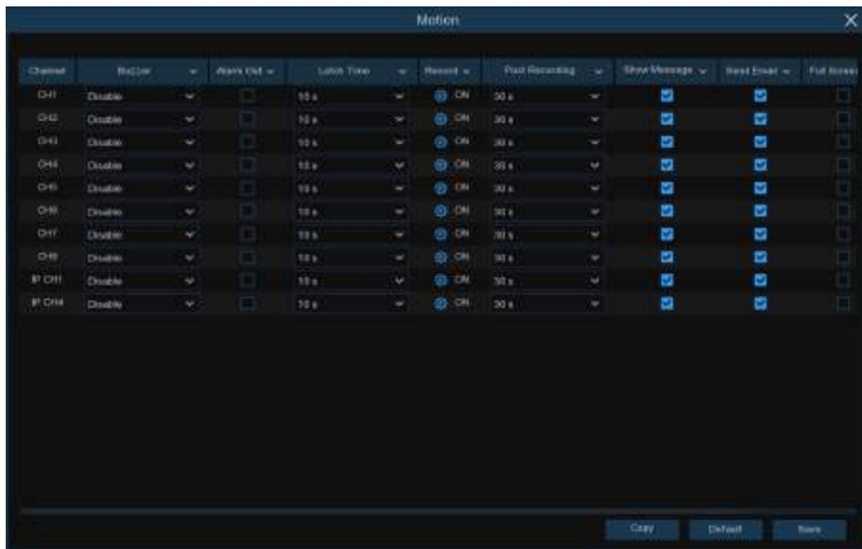
**Зуммер:** устройство может использовать внутренний зуммер в качестве сигнала тревоги. Вы можете установить продолжительность сигнала тревоги в секундах при обнаружении камерой движения в заданной области.
