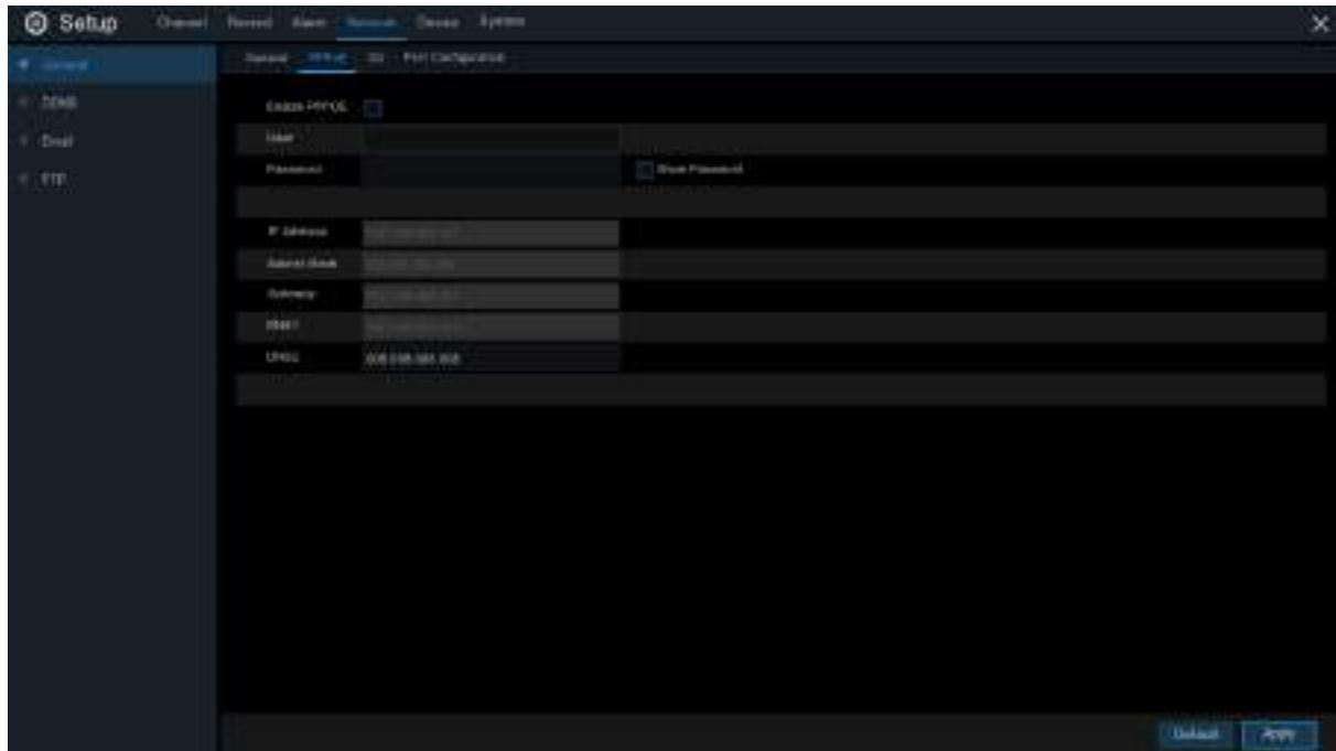
Это расширенный протокол, который позволяет DVR-устройству напрямую подключаться к сети через DSL-модем.
