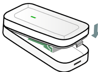
Рисунок 6.6 – Закрытие корпуса датчика
