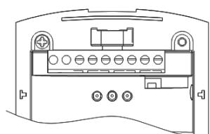
6. Проверьте работоспособность и закройте внешний кожух.
