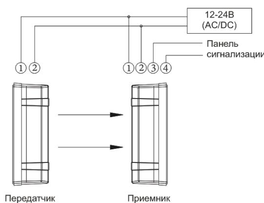
Подключение нескольких детекторов для увеличения высоты перекрываемой зоны, параллельное подключение линии питания, последовательное подключение тревожных выходов НЗ, ОБЩ.
