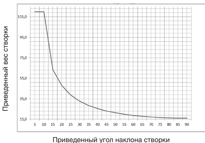
Рис. 8. График зависимости веса створки от приведенного угла наклона створки для верхнеподвесных створок (открытие наружу, ход цепи 400 мм)
