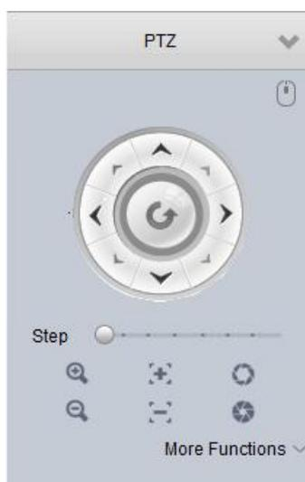
Управление PTZ перемещается в 8 направлениях, масштабирование, диафрагма, шаг и
