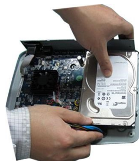
Падключыце SATA кабель і кабель харчавання на ніжняй і задняй частцы корпуса і зачыніце корпус верхняй вечкам.
