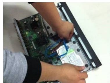
Подключите SATA кабель и кабель питания на нижней и задней части корпуса и закройте корпус верхней крышкой.
