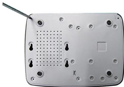
Закрепите жесткий диск на нижней панели при помощи винтов через соответствующие отверстия.
