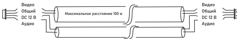
Рис. 18 Комбинированный видеокабель для подключения видеодомофона
