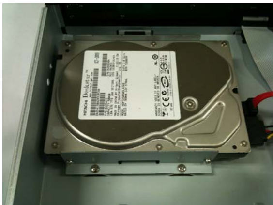
3. Установка HDD крепежных скоб на основной корпус (внутри)
