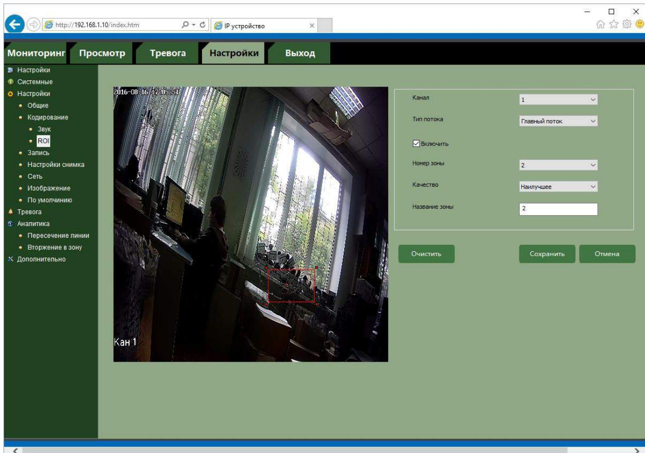
Функция ROI позволяет оптимальным образом сочетать небольшой размер трафика от камеры и высокое качество записи наиболее важных областей изображения.
