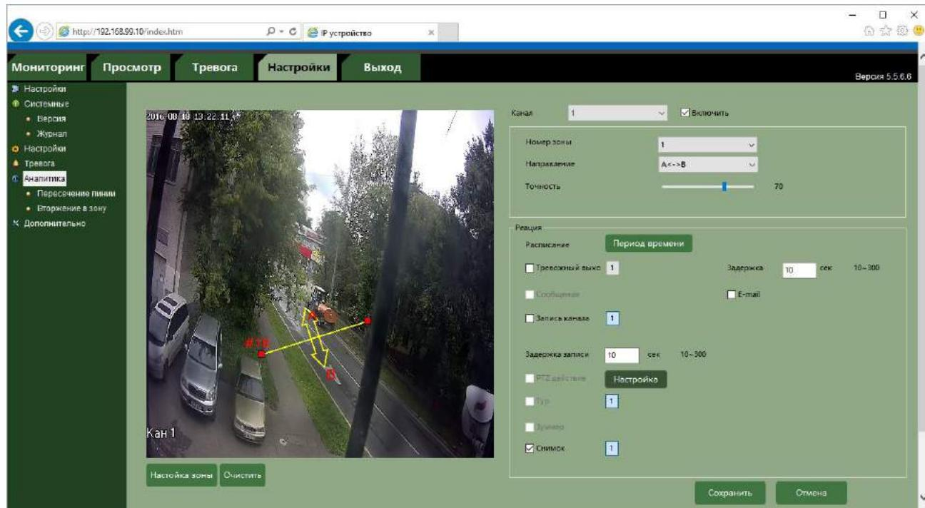
Камера позволяет включить до 4-х детекторов пересечения линии с различными настройками.
