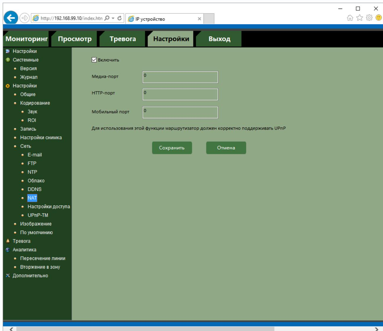
При поддержке роутером данной функции для того, чтобы обратиться к камере из Интернета (при условии, что сам маршрутизатор имеет выделенный статический IP адрес), достаточно просто включить в роутере поддержку UPnP, включить трансляцию портов через NAT в устройстве. При этом маршрутизатор сам будет транслировать через NAT обращение из Интернета к камере на соответствующие порты.
