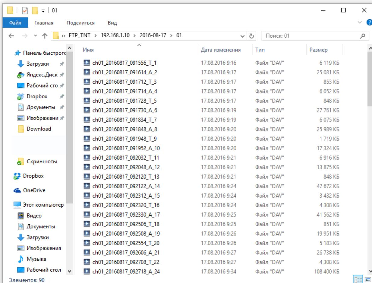
Камера записывает видеофайлы на FTP сервер в специфическом формате, совместимом с многоканальным форматом записи видеорегистраторов, поэтому для чтения файлов необходимо использовать ПО TS VMS из комплекта поставки камеры.
