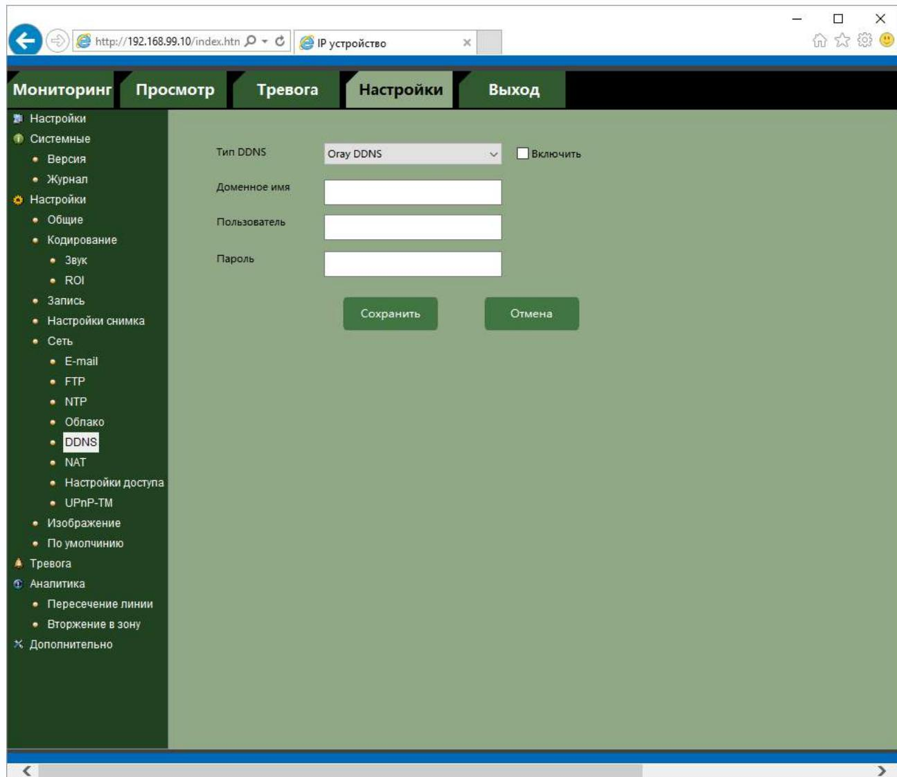
**Примечание.** В случае, если IP-адрес выдается компьютеру на определенное время, чаще всего лишь на один сеанс связи – такой адрес называют динамическим. В большинстве случаев для индивидуальных пользователей интернет – провайдеры выдают динамические IP-адреса. Однако, для того, чтобы можно было обратиться к оборудованию в любой момент, оно должен иметь постоянный адрес! С этой проблемой легко справляется служба Dynamic DNS (DDNS).
