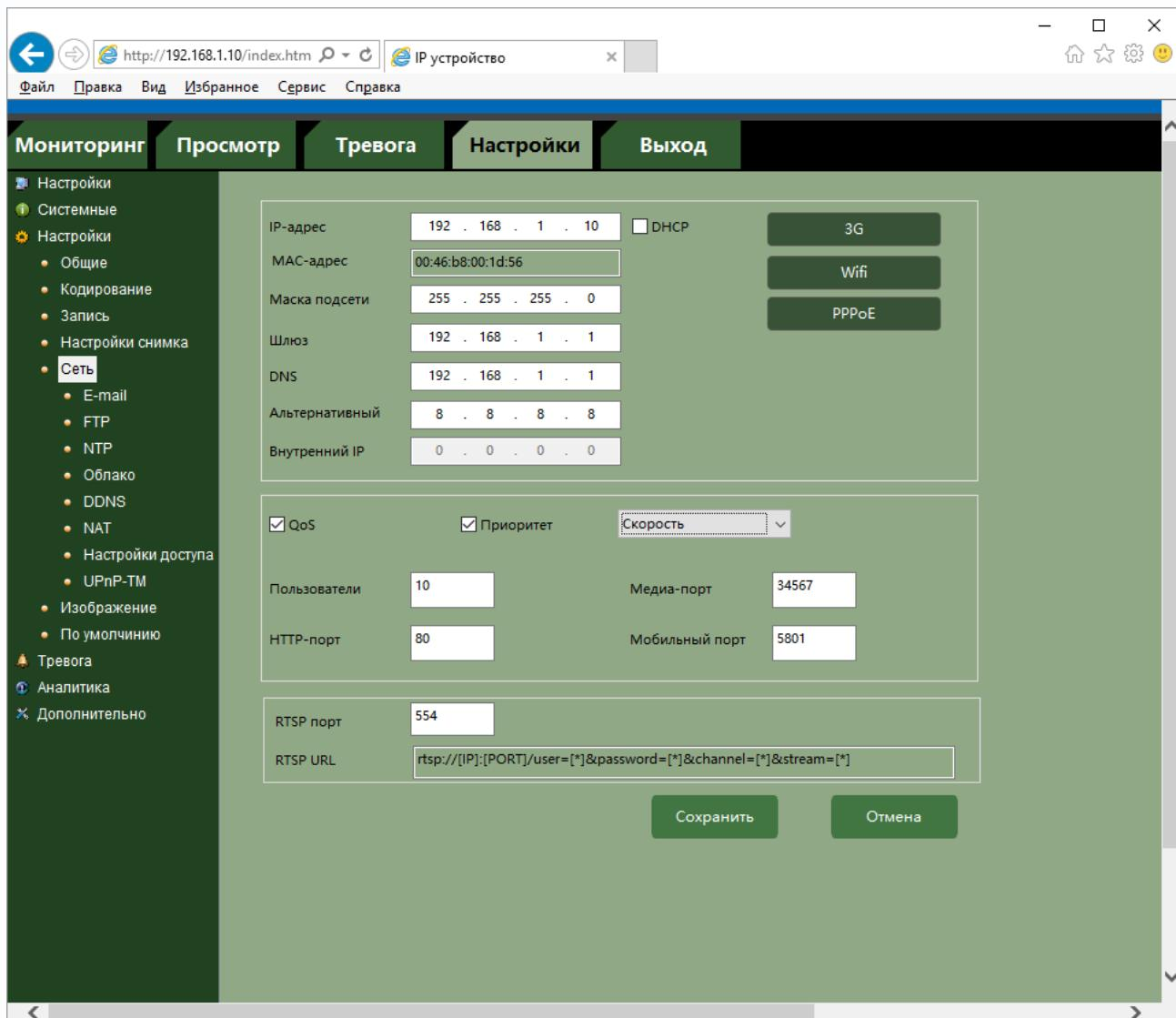
Для камеры можно задать получение IP адрес автоматически от DHCP сервера (при этом необходимо, чтобы сервер DHCP был в сети) при установке параметра **DHCP** либо вручную.
