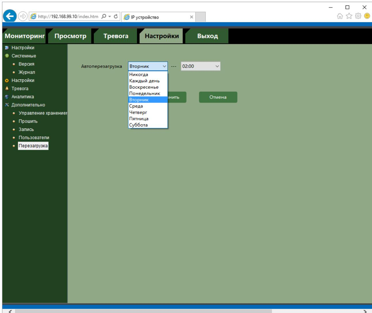
Можно настроить автоматическую перезагрузку в назначенное время каждый сутки, раз в неделю или отключить автоматическую перезагрузку.
