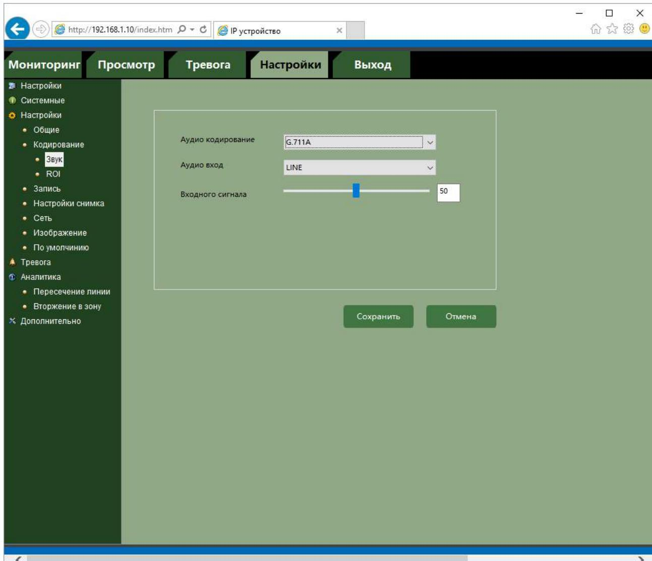
В меню **Аудио кодирование** выбирается тип кодека (пока доступен только G.711a).
