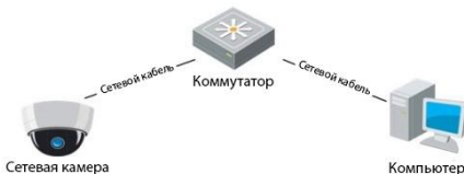
Рисунок 3-2 Соединение через коммутатор или роутер
