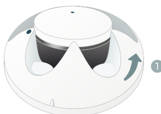
Рисунок 6.2 – Вскрытие корпуса датчика
