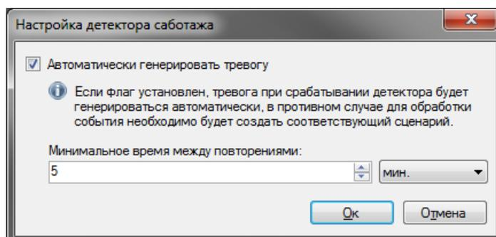
На рисунке выше представлено окно настройки параметров детектора саботажа. Флажок «Автоматически генерировать тревогу» как раз и определяет действие по умолчанию – генерация тревоги. Вы можете переопределить реакцию системы на событие, генерируемое модулем, отключив данный флажок и создав сценарий для его обработки.
