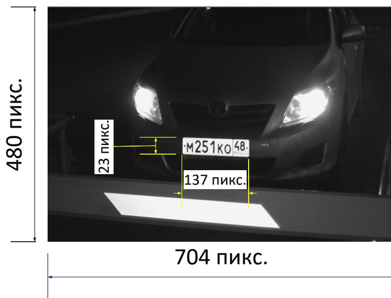
Исходя из того, что номерная пластина имеет размер 520x112 мм, а изображение номера должно быть не меньше 80x18 пикселей легко посчитать требуемое разрешение видеокамеры (по горизонтали):
