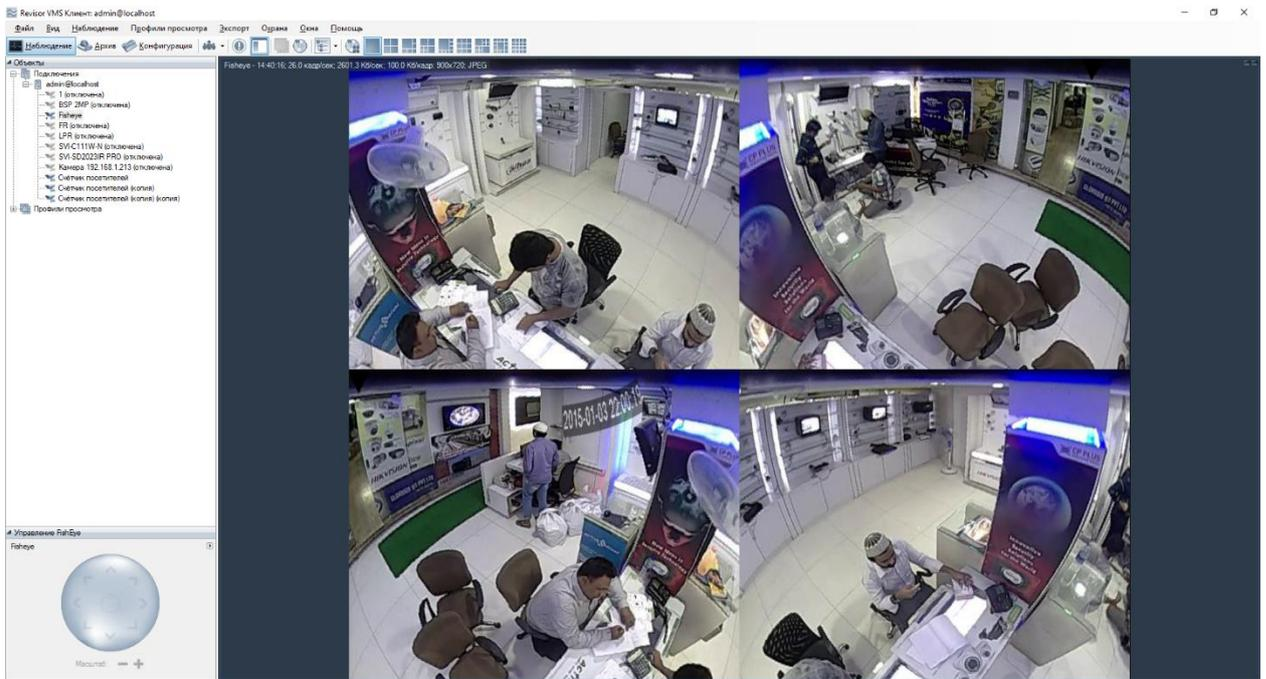
В левом нижнем углу доступно управление углами поворота и зумом через интерфейс виртуального PTZ.
