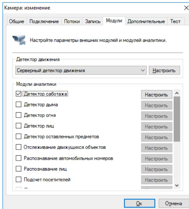
Обратите внимание, что модули работают в связке с серверным детектором движения, поэтому последний также должен быть включен.
