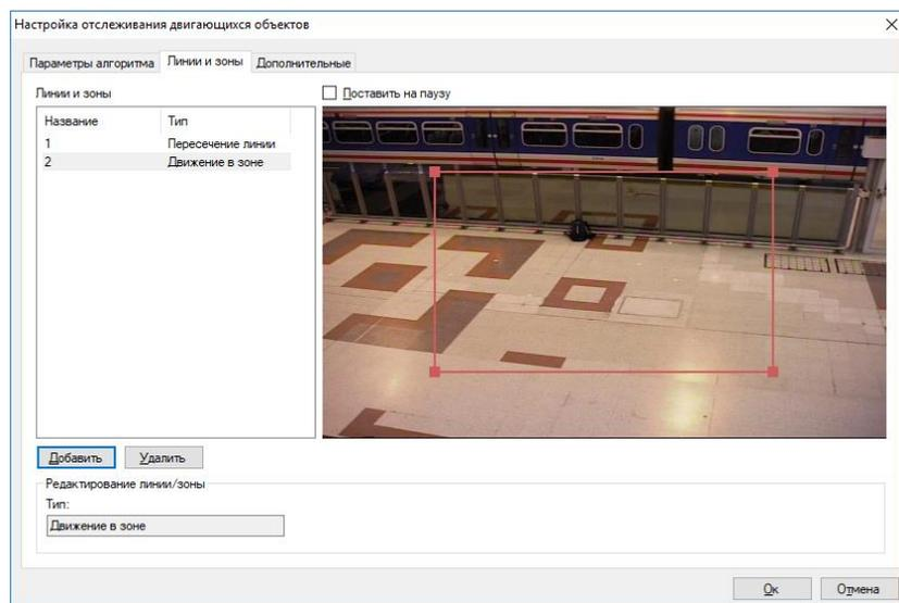
Если нажать на грань зоны ЛКМ, добавится дополнительная точка в виде заполненного прямоугольника. Пользователь может настроить зону индивидуально путем перетягивания данных точек. Ниже приведен пример интерфейса модуля с настроенной зоной.
