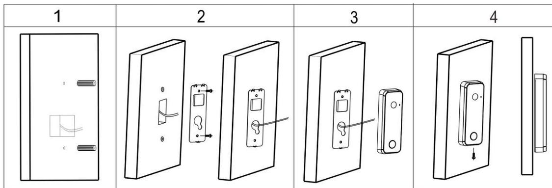
1. Наметьте и просверлите отверстия в стене для кронштейна и кабеля на нужной высоте.
