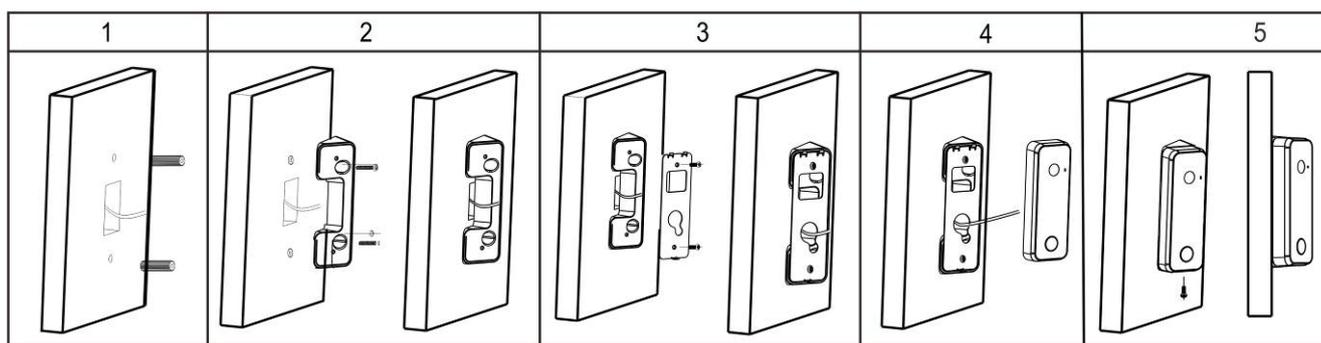
1. Наметьте и просверлите отверстия в стене для кронштейна и кабеля на нужной высоте.
