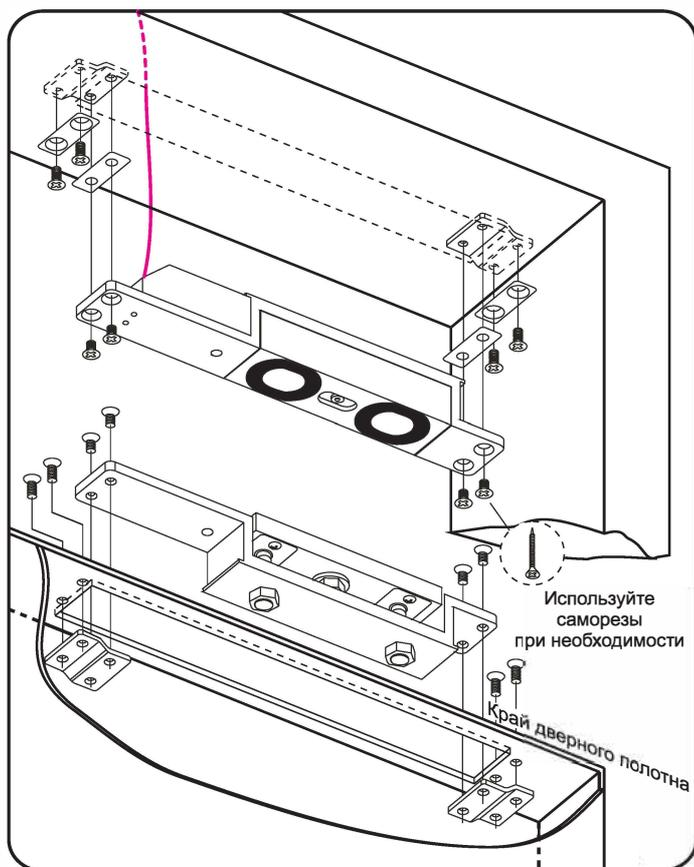
1. При монтаже замка постарайтесь максимально точно сопоставить электромагнит и ответную часть (чтобы при совмещении они совпадали).
