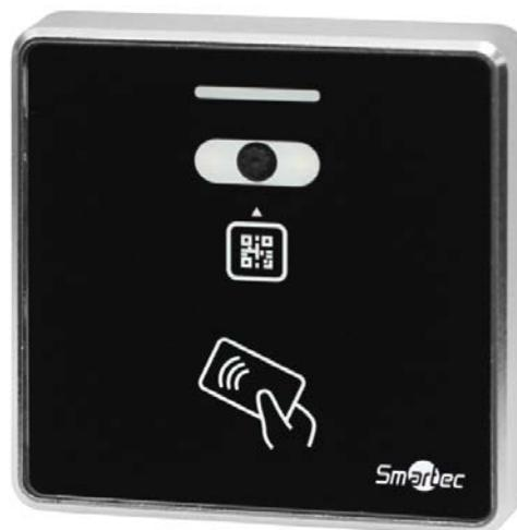
Считыватель ST-PR144QMF-BK предназначен для работы в составе систем контроля доступа с использованием карт формата MF и QR-кодов. Комбинированный считыватель позволяет реализовать решения, когда необходимо предоставить, как постоянный доступ пользователям с помощью карты, так и временный или разовый – с помощью QR-кода. Благодаря выходному интерфейсу Wiegand 26/34/58 данный считыватель совместим с любыми системами контроля доступа.
