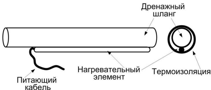
Рис.2. Монтаж обогревателя
